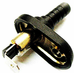
Rys. 12.3. Zestyk układu instalacji alarmowej: a) wygląd, b) umiejscowienie w drzwiach samochodu
