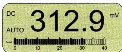
Rys. 3.3. Wygląd wyświetlacza multimetru cyfrowego z dodatkowym odczytem analogowym – bargrafem
