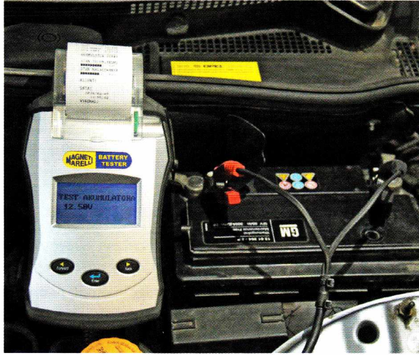
Rys. 4.14. Sposób oceny stanu technicznego akumulatora z wykorzystaniem pomiaru konduktancji/rezystancji (a) oraz przykładowy wydruk z wynikami pomiarów (b)
