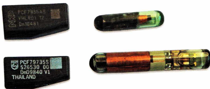
Rys. 12.15. Różnego rodzaju transpondery układu immobilizera
