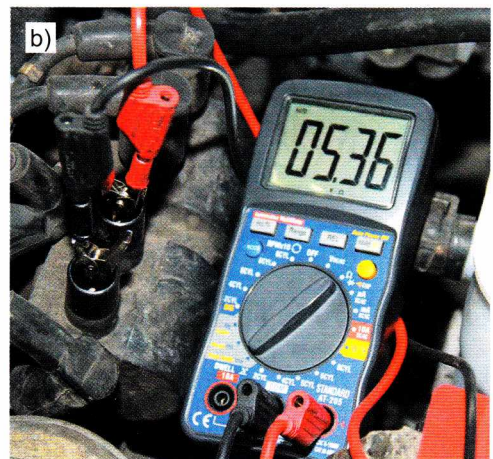
Rys. 7.5. Sposób pomiaru: a) napięcia zasilania cewki dwubiegowej, b) rezystancji uzwojenia wtórnego cewki
