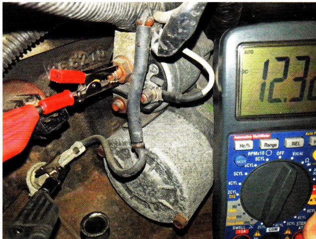
Rys. 5.4. Pomiar napięcia na zacisku 30. rozrusznika
