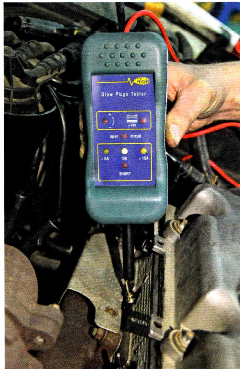
Rys. 5.15. Przykładowy tester do kontroli działania świec żarowych (a) oraz sposób podłączenia do testowanej świecy (b)
