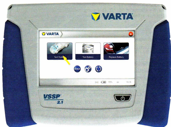
Rys. 5.8. Wygląd urządzenia do diagnozowania akumulatora systemu Start-Stop z czujnikiem stanu naładowania akumulatora i systemu zarządzania energią samochodu BMS (ang. Battery Management System )
