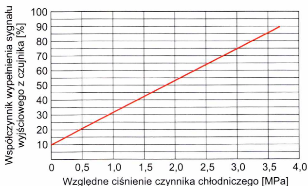
Rys. 10.35. Przykładowa charakterystyka czujnika ciśnienia czynnika chłodniczego w układzie klimatyzacji
