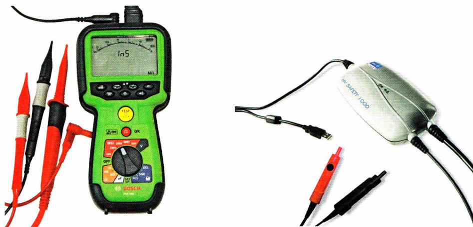
Rys. 13.6. Przystroje do kontroli izolacji przewodów wysokonapięciowych napędu hybrydowego i pomiarów parametrów elektrycznych
