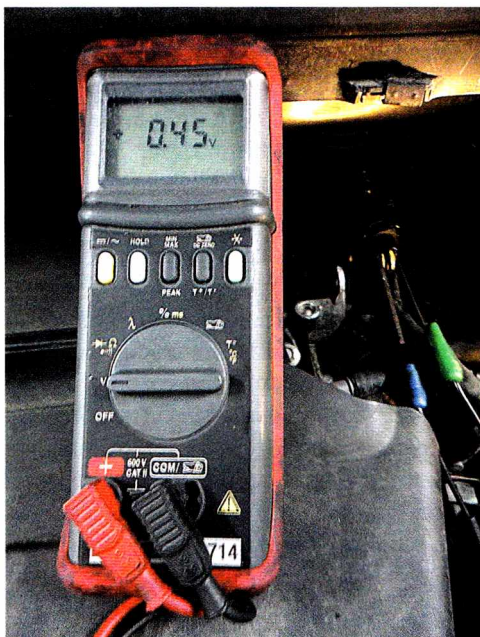
Rys. 6.32. Pomiar sygnału referencyjnego na ogniwie Nernsta szerokopasmowej sondy lambda podczas jej pracy
