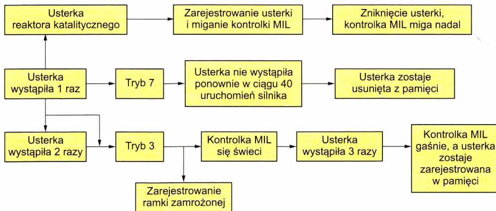
Rys. 6.2. Ogólny schemat wykrywania usterek przez system OBD II i wyzwalania świecenia się (lub gaśnięcia) lampki MIL
