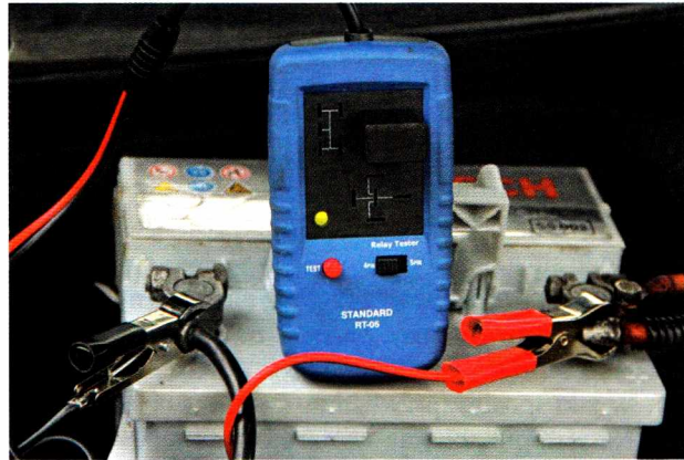
Rys. 6.49. Kontrola działania przekaźnika wentylatora przy użyciu testera przekaźników
