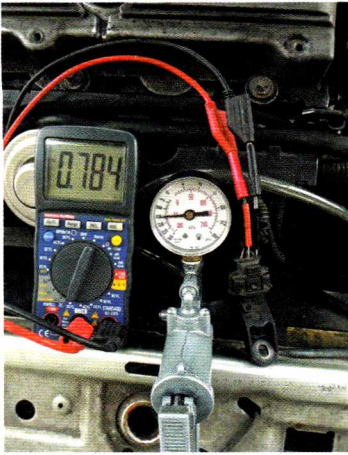
Rys. 6.21. Sprawdzanie czujnika ciśnienia powietrza za pomocą pompki podciśnienia/nadciśnienia i miernika (a) oraz interpretacja wskazań manowakuometru pompki (b)
